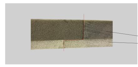
VIRIdiVITA ® premium roof wird fugenlos verlegt! (gestossen)
